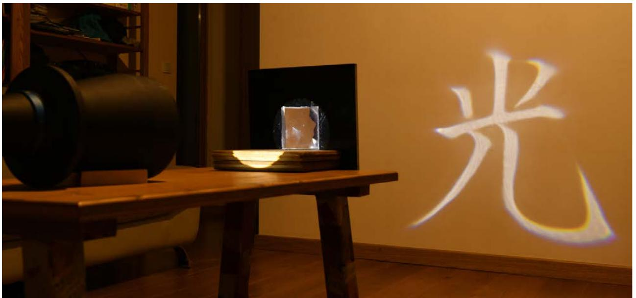
**Figure 2 :** Prototype physique. La lumière parallèle uniforme (comme les rayons du soleil) se projette sur un mur après réfraction à travers la lentille. La lentille a été conçue de telle manière à ce que l'image projetée forme le caractère japonais Hikari. (Photo issue de la l'article paru dans *ACM Transactions on Graphics*. Crédit : Mériqot / Meyron / Thibert)
