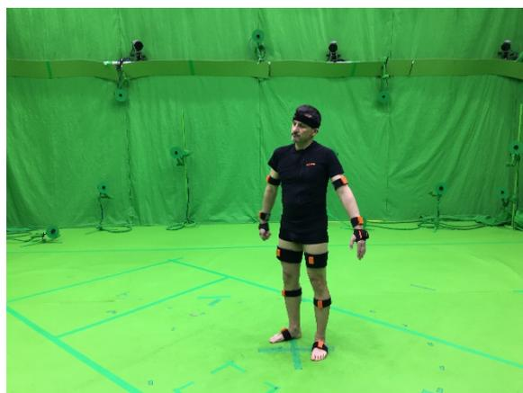
*Batterie de tests, avec et sans armure, effectués sur la plateforme Kinovis à L'Inria. 68 caméras, 13 ordinateurs et trois jours de calculs à chaque fois... L'idée est de pouvoir mesurer le plus finement possible les contraintes de l'armure pour chacun des expérimentateurs.*
